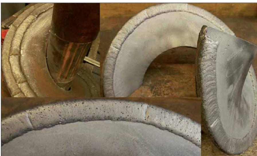
Alliage nanostructuré DO\*390N appliqué sur une vis
