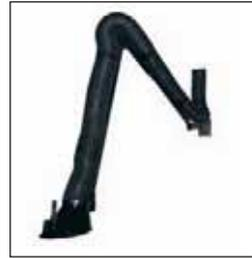
Bras articulé autoportant avec tuyaux souple et système d'articulation à 180°. Il est particulièrement conseillé pour l'aspiration de fumée, de vapeur, de poussières et de copeaux. Le bras est fourni avec une articulation externe, une platine de fixation et d'un tuyau de raccordement en diamètre 150 mm.
