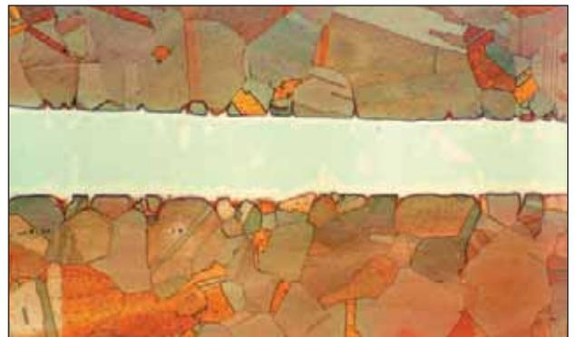
Grossissement des grains observé dans le cas du brasage fort à l'aide d'un alliage Cu-P-Ag
