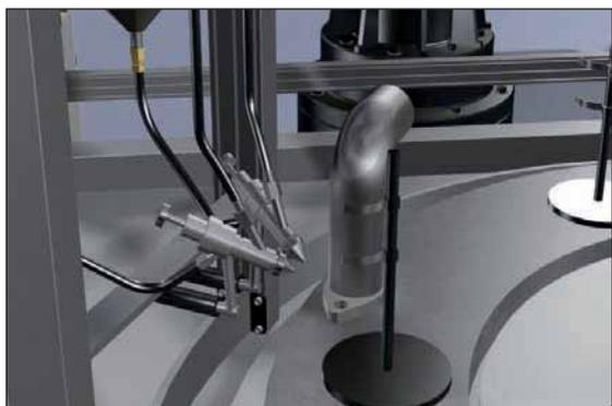
*Dépôt automatisé de pâte par seringue durant la production*
