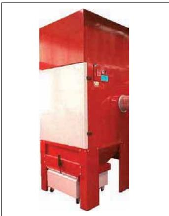
Groupe d'aspiration et de filtration pour les fumées de soudure, de découpe plasma et les poussières métalliques. La filtration est assurée par des cartouches en polyester USGC/A nettoyées par un système de décolmatage par jet d'air comprimé. Le système de décolmatage est programmable par gestion électronique.
