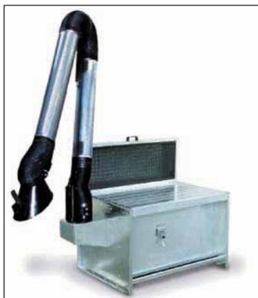
Table aspirante en acier pour l'aspiration des fumées, des vapeurs et des poussières. La version BSA est fournie avec un ventilateur aspirant et un bras articulé Techno de 3m. Raccord de sortie :  $\varnothing$  200 ou  $\varnothing$  250 mm.
