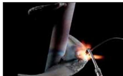
*Traitement anti-usure de vis de transport*
