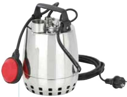
Pompe inox à roue multi-canaux ouverte avec double garniture mécanique en oxyde d'alumine/carbone dur, dans chambre à huile.
