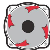
Système d'évacuation des impuretés à l'intérieur de la chambre du rotor
