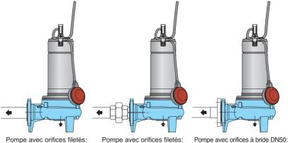
Pompe avec orifices filetés: tuyaux vissés dans les orifices
