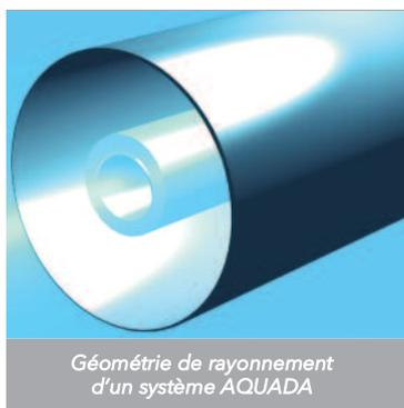
Les Aquada sont constitués d'une lampe basse pression placée dans une gaine de quartz, assemblées toutes deux dans un tube cylindrique. Les rayons ultraviolets sont produits par des lampes avec une longueur d'onde de 254 nm particulièrement efficace pour la désinfection.
