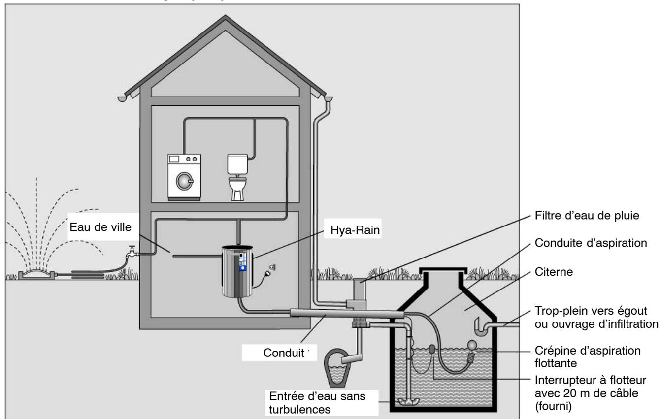
Le trop-plein doit être raccordé à une bouche d'évacuation ou à l'égout en assurant une rupture de charge, avant déversement, par mise à l'air libre. La fermeture de l'orifice de trop-plein avec un bouchon est strictement interdite.
