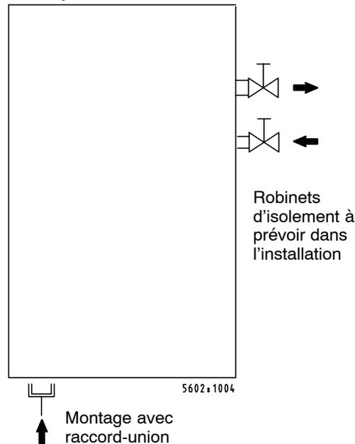
**Gabarit de perçage pour fixation murale Raccordement eau de ville et trop-plein**
