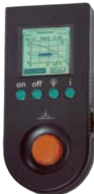
Fig. : moniteur IR Wilo ; Organe de commande et de service pour analyse de pompes
