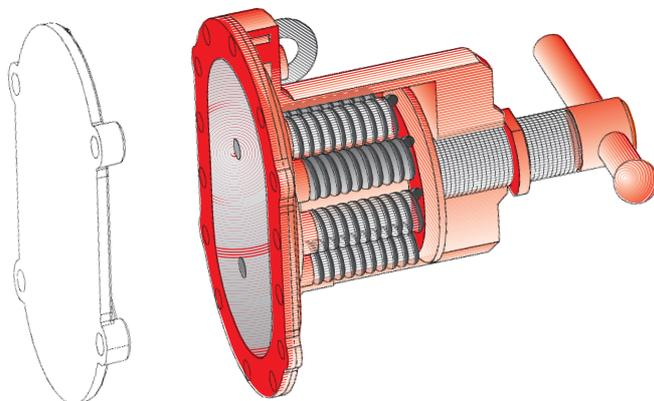
La pression de refoulement (pression process) s'exerce à l'intérieur du corps de la pompe. A son extrémité, la plaque d'usure avant se déplace axialement sous l'effet de multiples ressorts précontraints.
