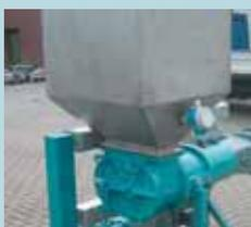
**Les déchets alimentaires** sont utilisés dans la production d'aliments pour animaux ou encore comme combustible dans la production de biogaz. Le broyeur Unihacker est utilisé avec succès dans ce type d'activité. La taille des résidus est déterminée par l'épaisseur des couteaux et la vitesse de rotation.
