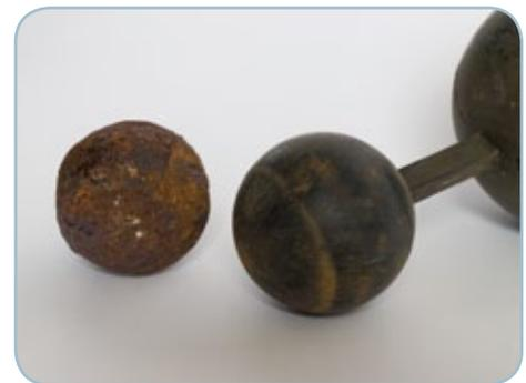
Un an après l'installation, voici à quoi ressemble une bille en métal utilisée, en général, dans les vannes de brassage de la concurrence (à gauche) et la bille en caoutchouc FLX Zenit.
