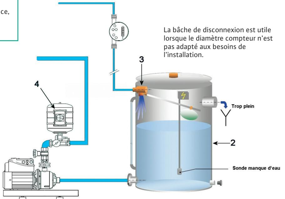
La bâche de disconnexion est utile lorsque le diamètre compteur n'est pas adapté aux besoins de l'installation.
