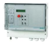
Les coffrets de commande ne sont pas "anti-déflagrants" et ils seront donc placés uniquement en dehors de la zone à risques. Coffret de commande, pour le pilotage, à partir d'un détecteur de niveau, de 2 pompes submersibles. La détection des niveaux peut se faire par détection pneumatique : cloche à air ou compresseur, par un capteur électronique (4 – 20 mA) ou avec des contacteurs à flotteur.
