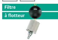
Filtre d'aspiration flottant à grosses mailles G/GR de 1,2 mm et à fines mailles F/FR de 0,23 mm. Filtre d'aspiraton, avec flotteur, avec raccord-tuyau 11/4" pour l'aspiration d'eau de pluie préfiltrée. Raccordement avec un tuyau flexible armé (à commander séparément) à une pompe immergée de la série Wilo-Sub TWU 5-SE... Exécution avec raccord-tuyau 11/4" sans clapet anti-retour.
