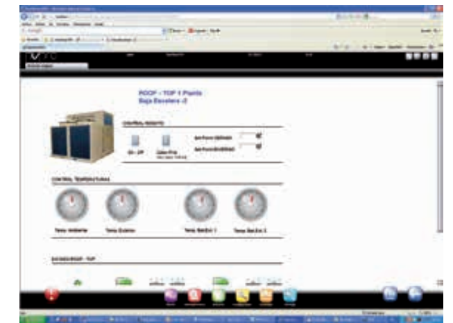
Écran personnalisé pour Roof Top, contrôle de base de l'unité : permet de faire les opérations de base : ON-OFF, changement froid/chaud, modifier setpoints températures et visualiser l'état des principaux composants.
