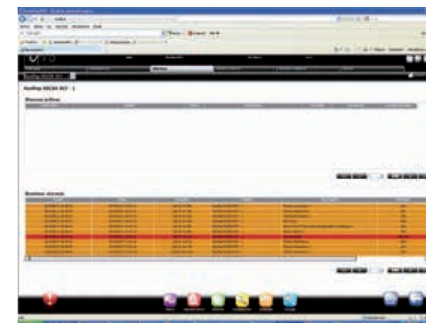
Écran avec liste complète des alarmes (accès selon le niveau de l'utilisateur) : permet de visualiser les alarmes et de les réinitialiser.
