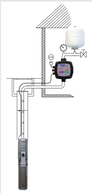
En développement continu de produits novateurs dans un esprit de QUALITE, Well Pumps est fière de vous présenter le Système de Pompage à Pression Constante WPS-CP. Les avantages du système sont légions: facile à installer, fiable, haute qualité et économie d'énergie. Les pompes sont disponibles avec une hauteur manométrique jusque 140 m et un débit jusque 6,5 m<sup>3</sup>/h.
