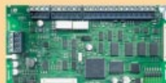
entièrement CONTROLE par MICRO-PROCESSEUR y compris commande séquentielle de pompe, commutation automatique en cas de défaut, de démarrages en cascade
