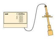
Un capteur de niveau à ultrasons est placé dans la trémie intermédiaire. Le convertisseur de mesure transmet les signaux pour assurer un mélange optimal des substances auxiliaires.
