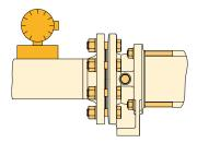
Au dépassement de la limite de pression configurée dans le dispositif de contrôle, la pompe est mise à l'arrêt automatiquement.
