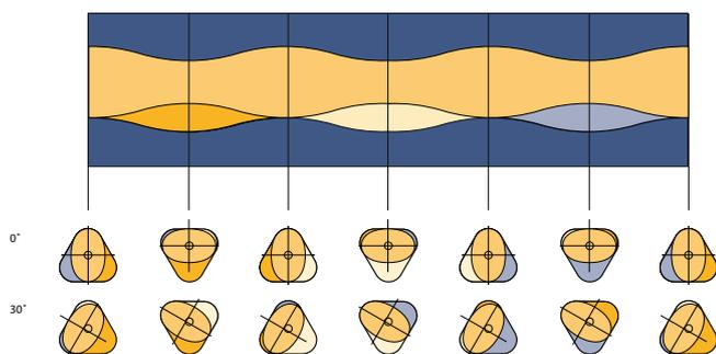
La géométrie en T a été développée à partir de l'expérience acquise avec la géométrie en L. Avec une vitesse constante, le débit est augmenté de 50 %.
