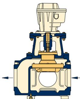
Les dilacérateurs sont utilisés en général dans le traitement des eaux usagées par l'industrie et les sociétés de service. Ils réduisent les composants solides et fibreux dans les eaux usagées et les boues. Ils assurent le bon fonctionnement des pompes Verderpro est garantissent une durée de vie prolongée. Les substances sont coupées et non pas déchirées, ce qui rend la machine particulièrement rentable. Débits 2-150 m<sup>3</sup>/h
