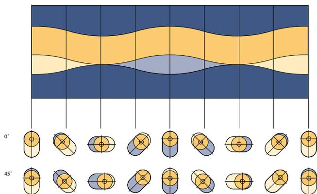
Par rapport aux exécutions en géométries conventionnelles, le rotor en géométrie en L possède un pas plus grand avec un diamètre inférieur et une faible excentricité. Ainsi, la ligne d'étanchéité devient plus longue et la vitesse de glissement est réduite d'environ 20 %. Grâce à cela, la durée de vie est considérablement améliorée. Même en pompant des fluides très abrasifs, le débit et la pression de travail restent constants pendant longtemps.
