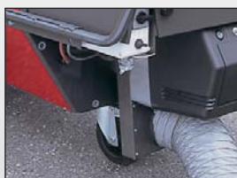
Prises extérieures d'air de combustion
