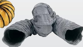
Fibre de verre enveloppé de néoprène, -20/+140°C
