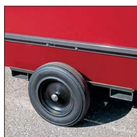
Passage pour les fourches du chariot élévateur disponible pour les IMA.
