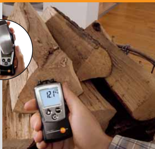
Mesure d'humidité sur une bûche de bois
