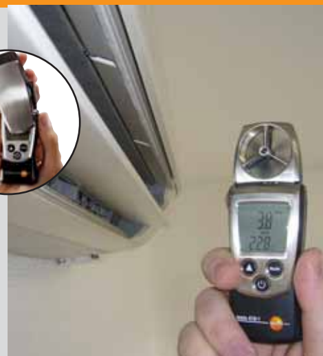
Mesure de vitesse d'air sur un split
