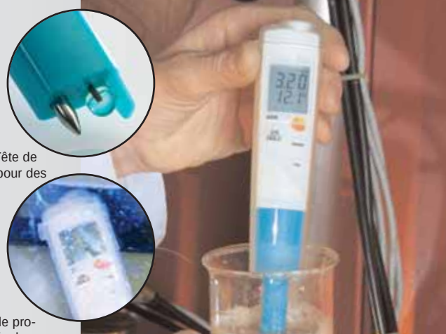
Contrôle rapide du pH, par exemple sur des rejets d'eau
