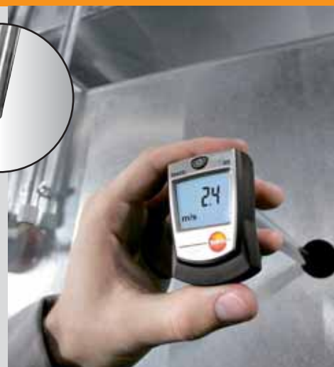
Mesure de vitesse d'air
