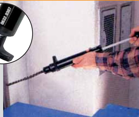
Pompe suie, pour vérification de l'indice de noircissement
