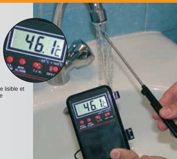
Mesure de la température de l'eau chaude
