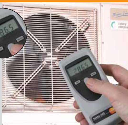
Mesure de vitesse tachymétrique
