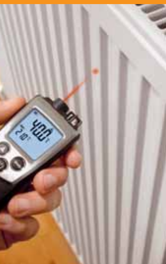
Contrôle de température sur un radiateur
