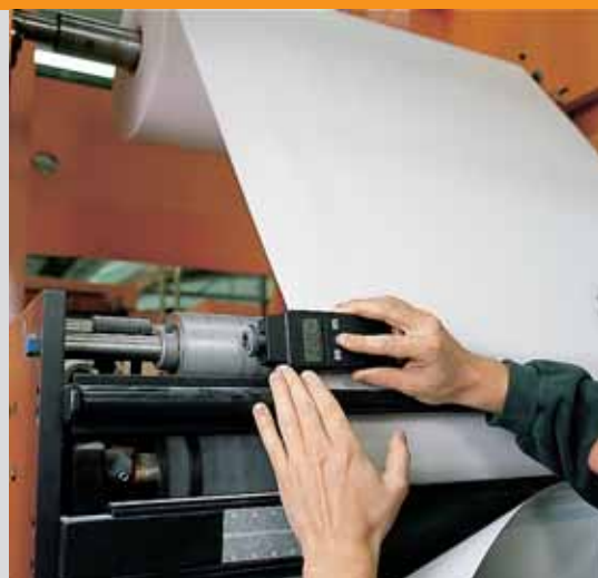
Mesure mécanique de la vitesse de rotation d'un tambour
