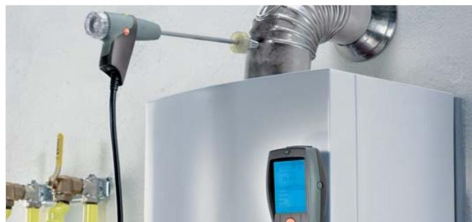
La mise en œuvre des techniques de mesure appropriées permet de déterminer et de régler le rendement optimum de la chaudière. L'analyse du potentiel d'économie validée par des données de mesure constitue alors la base pour un conseil spécialisé dans l'optimisation ou l'investissement dans une installation neuve ou remplacée.
