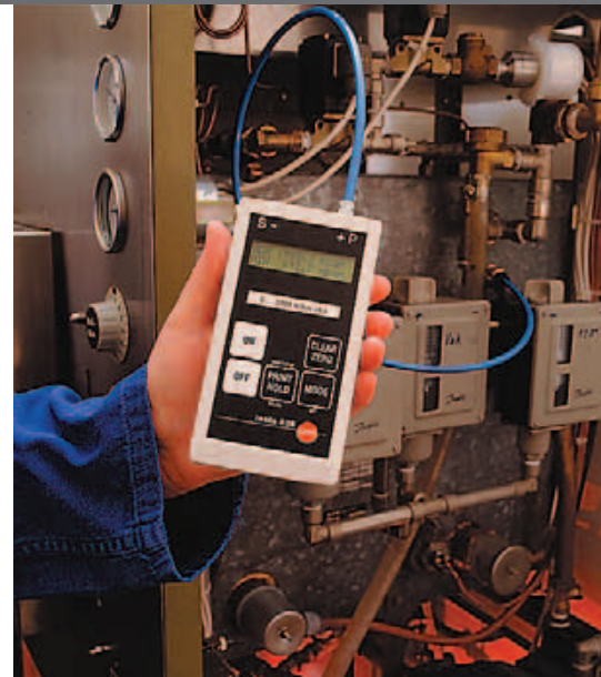
Mesure de la pression absolue sur un autoclave dans le domaine médical
