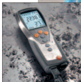
Un appareil de mesure robuste et fiable, classe de protection IP65 contre les chocs et les coups
