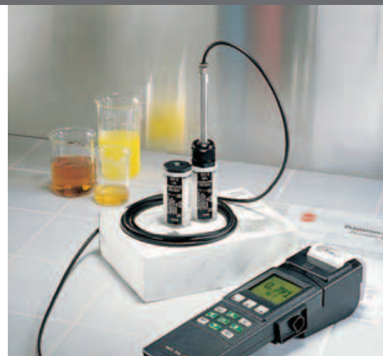
Flacon de contrôle et d'étalonnage sert à recalibrer les sondes d'humidité sur site
