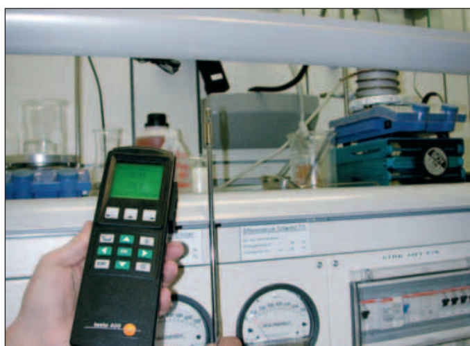
Contrôle sur site d'une aspiration de laboratoire avec le testo 400
