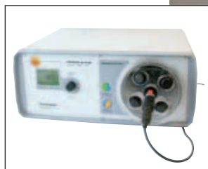
Etalonnage humidité simple et rapide d'appareils de mesure, de sondes et d'enregistreurs de données
