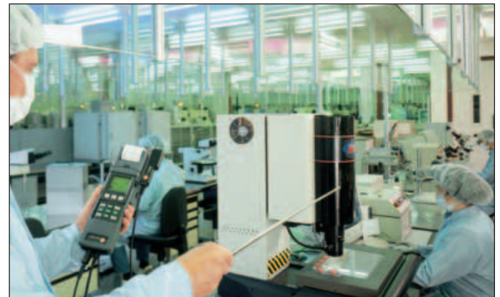
Contrôle de la vitesse du courant avec la sonde thermique réf. 0635 1041
