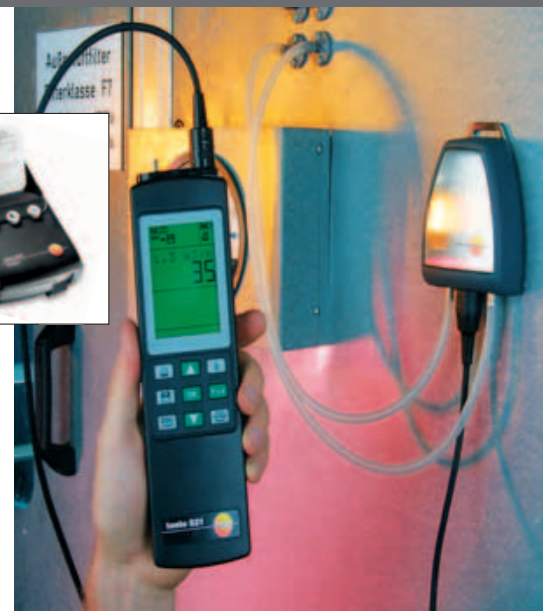
Contrôle de filtre avec sonde externe 10 Pa
