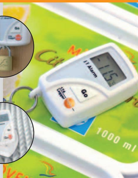
Contrôle des marchandises sensibles par exemple dans les chambres froides lors du transport dans les containers
