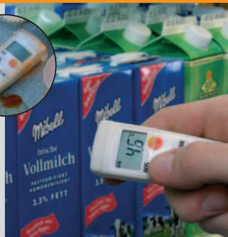
Mesure de température dans une armoire réfrigérée
