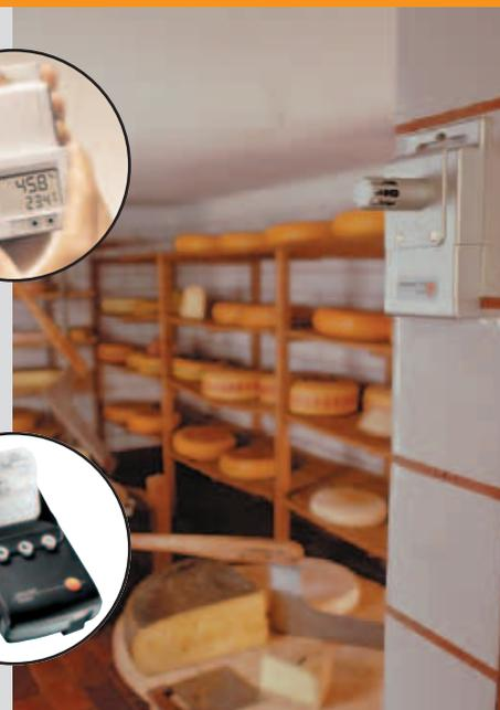
Surveillance de la température et de l'humidité dans des entrepôts
