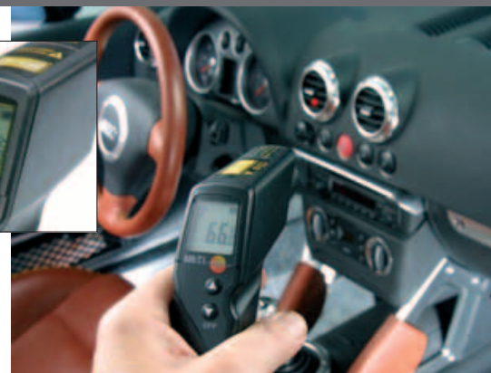
Contrôle de température sur une gaine de ventilation
