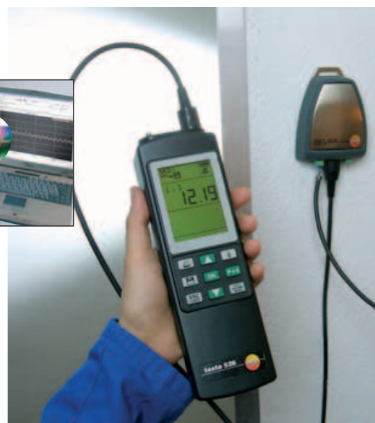
Vérification des convertisseurs de données avec l'interface 4...20 mA
