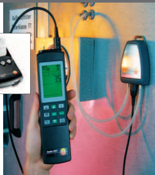
Contrôle de filtre avec sonde externe 10 Pa
