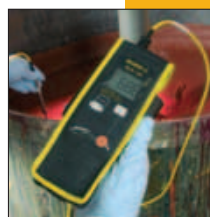
Contrôle de la température en zones dangereuses
