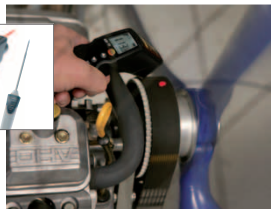
testo 830-T3 spécial pour les surfaces à petits diamètres, p.ex. pour les mesures de température sur des courroies
