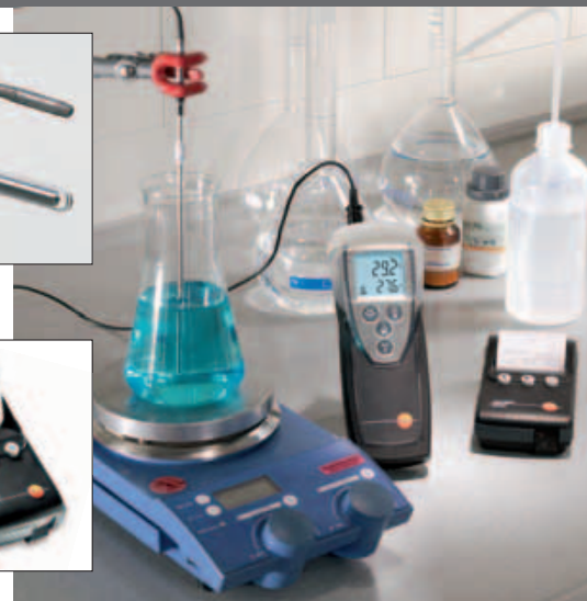
Mesure précise de la température dans un laboratoire de produits alimentaires, testo 720 et son étui de protection TopSafe
