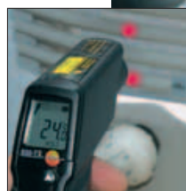
Visée laser 2 points (point de mesure réel)
