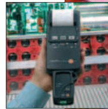
Documentation rapide des données avec l'imprimante IR sur site, 6 lignes/sec
