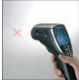
Optique commutable 1: champ distant 75:1 (16 mm, distance 1200 mm) avec marquage laser croisé
