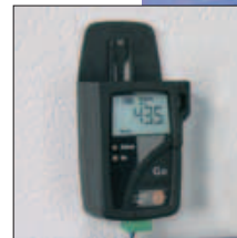
testo 175-S2 avec afficheur: affichage d'une valeur directement mise à l'échelle
