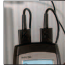
testo 922, mesures simultanées de deux températures, et affichage du delta de température
