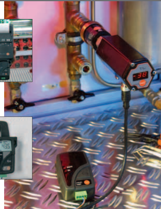
Enregistrement des signaux courant émis par un transmetteur avec le testo 175-S1 (sans afficheur)
