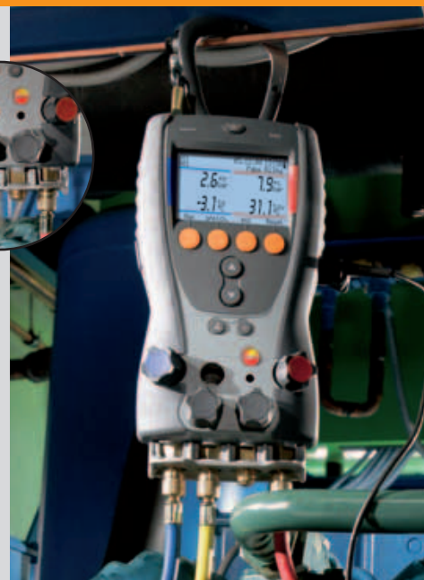
Mesures sur une pompe à chaleur
