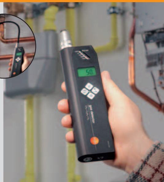
Localisation et détection des fuites sur les installations
