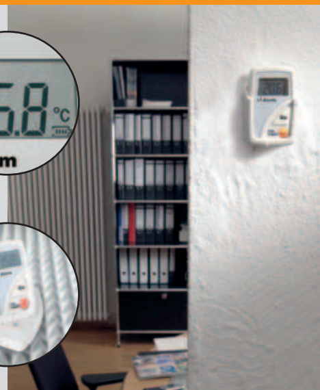
Enregistrement de température ambiante avec alarme immédiate lors de dépassement de seuil haut ou bas
