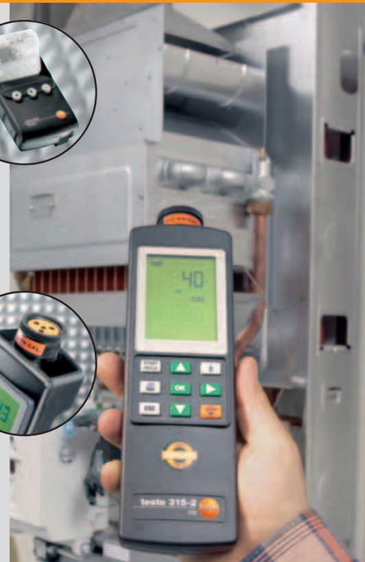
Mesure de sécurité du CO ambiant
