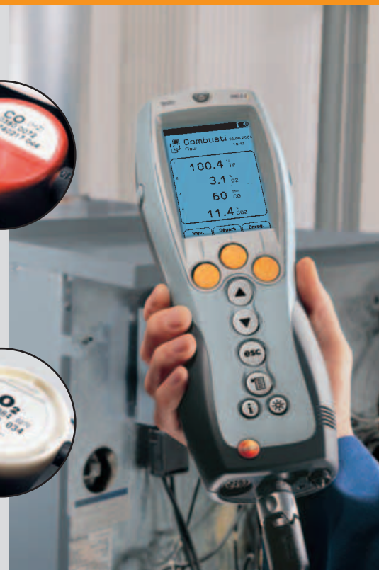
Contrôle rapide des valeurs gaz de combustion sur des installations de chauffe
