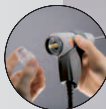
Le filtre de la sonde est placé en amont de la tuyauterie
