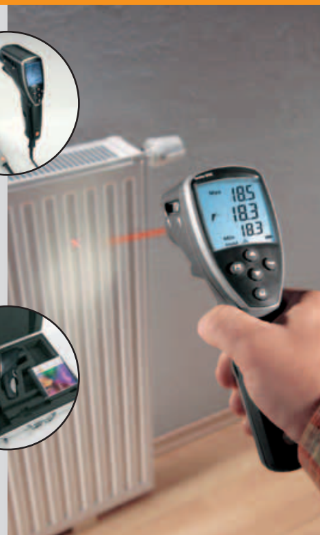
Contrôle de la température de surface
