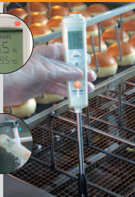
Contrôle de l'huile de friture industrielle et réglage du point de friture optimal dans une friteuse industrielle
