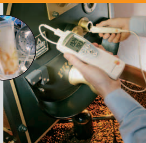
Contrôle de température dans une torréfaction
