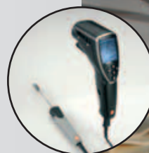
Entrée de sonde TC pour la détermination du coefficient d'émissivité
