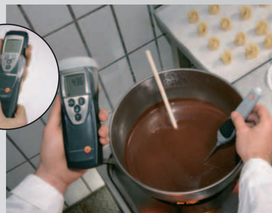
Vérification de la température exacte de chocolat fondu, pas de câble gênant grâce aux sondes radio
