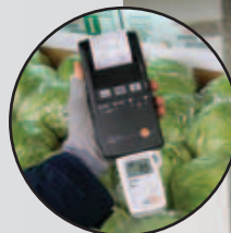
testo 177-T2 avec affichage, documentation rapide des données avec l'imprimante rapide testo 575
