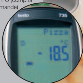
Affichage du lieu de mesure et des grandeurs de mesure. Jusqu'à 99 désignations de produits peuvent être documentées dans l'appareil.
