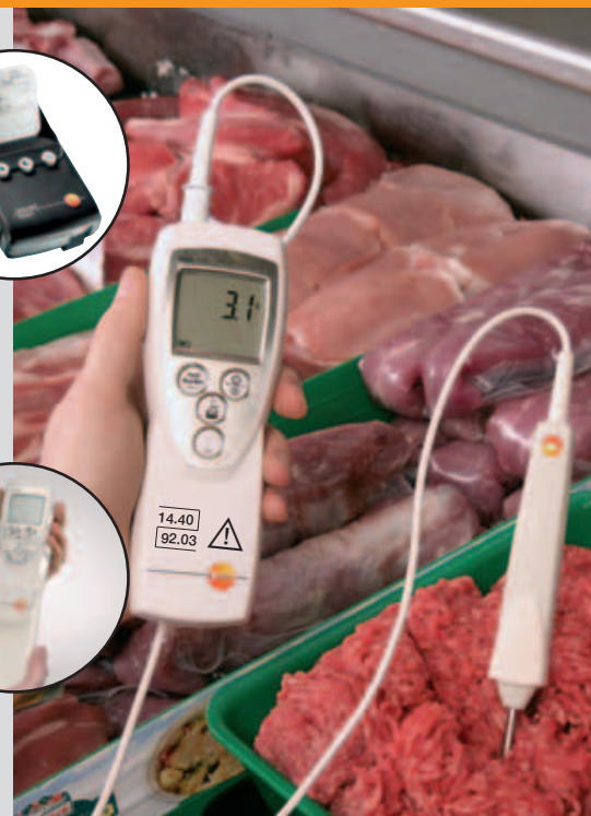
Contrôle de la température dans un comptoir réfrigéré
