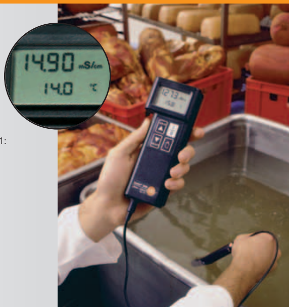
Détermination de la teneur en sel (NaCl) lors de la salaison
