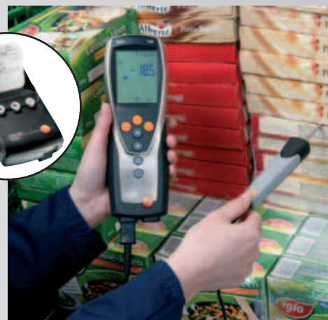
Contrôle par échantillonnage dans les chambres froides
