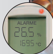
Affichage 2 lignes avec une alarme lors d'un dépassement de valeur limite
