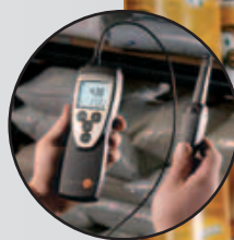
testo 625 avec poignée et câble de capteur de 160 cm
