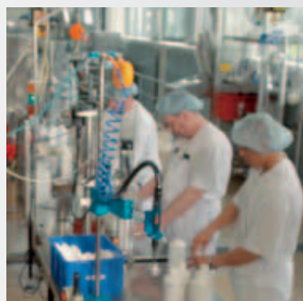
Dans les process de remplissage, il s'agit d'éviter les surpressions provenant de secteurs alentours polluants
