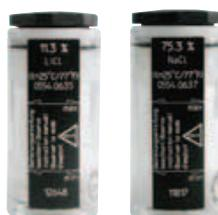
Set de contrôle et d'étalonnage de l'humidité
