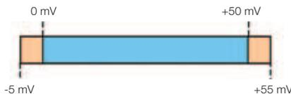
Les valeurs maximales en °C correspondent aux tensions maxi d'entrée (-5 mV...+55 mV), pouvant être traitées par les transmetteurs (tension thermoélectrique cf. IEC 584-1).
