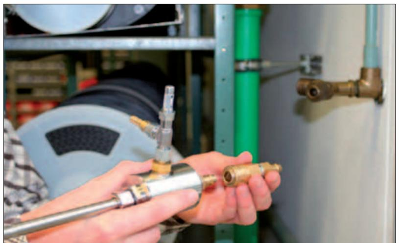
Raccordement de la sonde d'humidité résiduelle testo 6615 via chambre de mesure et pré-filtre
