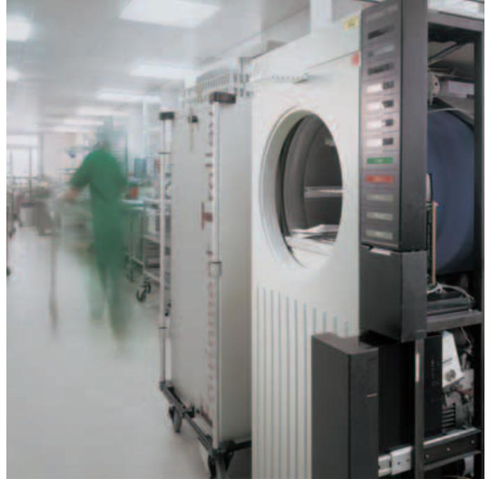
La fabrication de produits stériles gagne en importance. Avec l'hygrotest 650 version G8H8, il est possible de mesurer les valeurs d'humidité et de température dans un environnement H<sub>2</sub>O<sub>2</sub> en continu.
