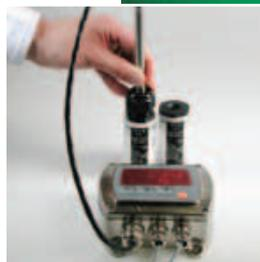
Les solutions salines réutilisables sont destinées sur site au contrôle et à l'ajustement des 2 points %HR
