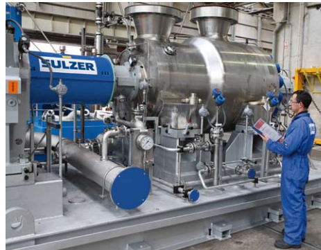
Sulzer construit les pompes d'injection d'eau les plus puissantes au monde qui maintiennent une haute pression dans les champs pétrolifères pendant tout le cycle de la production.
