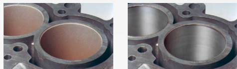
Processus de traitement des alésages des cylindres, à gauche avec revêtement au plasma, à droite après finition.
