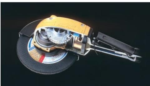
Meuleuse à main Atlas Copco GTG 40 équipée de deux roulements hybrides 627 SKF.
