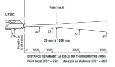
Diamètre de la cible au niveau du nez de l'appareil : 23 mm
