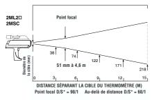
Diamètre de la cible au niveau du nez de l'appareil : 23 mm
