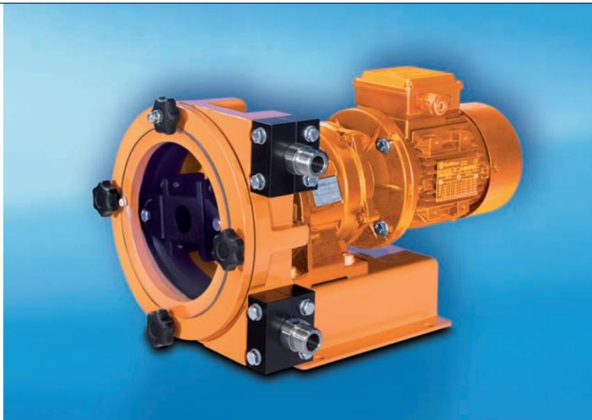
La pompe péristaltique DULCO®flex DFBa est conçue pour les débits de refoulement faibles et moyens jusqu'à 375 l/h à 8 bar. Équipée de rouleaux et de tuyaux renforcés de tissu, elle convient aux utilisations industrielles difficiles.
