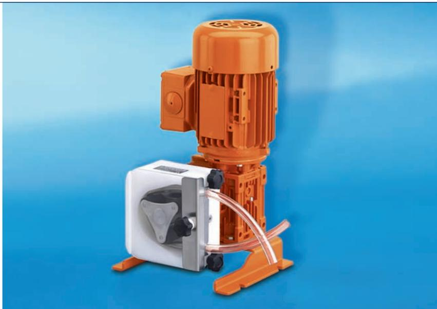
La pompe péristaltique DULCO®flex DFAa est conçue sous la forme d'une pompe basse pression et est destinée aux applications en laboratoire ou OEM. Elle convient au dosage exact des petits débits de dosage, jusqu'à 84 l/h à 2 bar. Le rotor est équipé de 3 rouleaux pour réduire les pulsations. Une fermeture rapide permet un changement rapide du tuyau.
