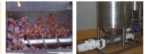
Prunes dans la trémie d'une pompe Pompe avec trémie montée sous une cuve de stockage
