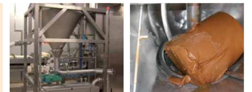
Viscofeeder™ PCM utilisé pour le dosage de pâte en pâtisserie industrielle Caramel dans la trémie d'un Viscofeeder™ PCM
