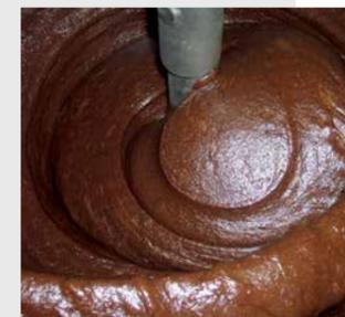
Transfert de chocolat à forte viscosité pour injection dans des desserts avec le Viscofeeder™ de PCM
