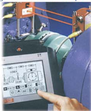
Alignement Laser sur pompes
