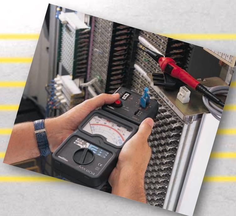
Testez vos parafoudres et vos résistances d'isolements sur le terrain, in-situ ou démontés !
