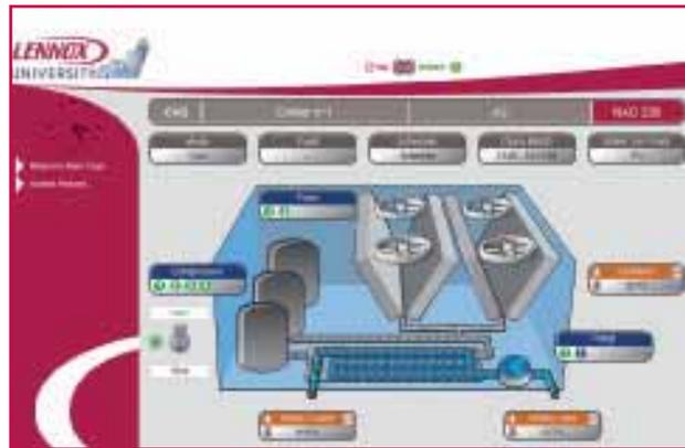
**ADALINK** est la solution de LENNOX pour la supervision des installations de climatisation. Il permet de contrôler jusqu'à 16 unités sur le même site. Il peut être connecté à des unités différentes de la gamme Lennox, rooftop set refroidisseurs de liquide.
