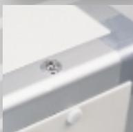
**La structure** : la structure du caisson est construite en profilé d'aluminium anodisé, les coins en polypropylène renforcé. Les panneaux sont à double paroi isolée en EPS traité de 15 mm. La couleur est beige RAL9002. La structure est pourvue d'écrous M8 permettant la fixation de l'appareil par tiges filetées.
