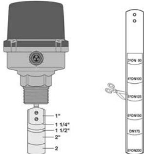
Le flussostat doit être monté sur la tuyauterie si possible à l'horizontale, en respectant le sens du flux indiqué par la flèche placée sur le couvercle et à l'extérieur du corps. Pour que la lamelle fonctionne correctement, le flussostat doit être monté à la hauteur indiquée sur le dessin.
