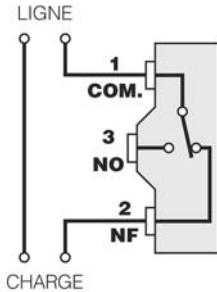
Quand le flussostat est utilisé pour activer un dispositif en **présence de débit**.
