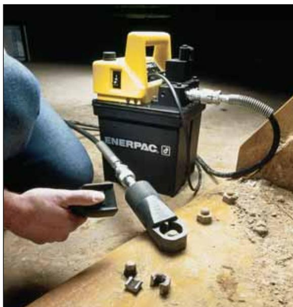
◀ La pompe immergée PED-1001E, qui actionne ce casse-écrous, permet d'effectuer rapidement et silencieusement le travail de maintenance de cette benne.
