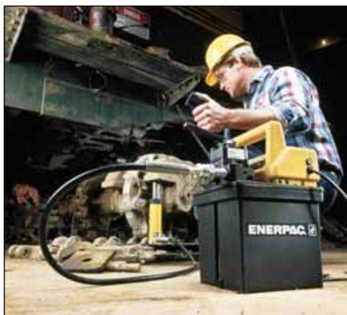
◀ Le modèle avec télécommande à impulsions de la pompe immergée simplifie la réparation de cette grue de chantier.
