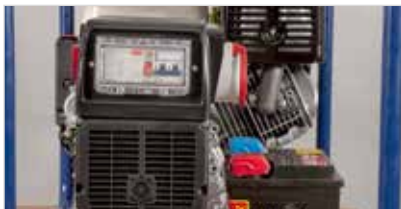
Quadro elettrico superiore trifase con magnetotermico Upper three-phase electrical panel with thermal cut-out protection
