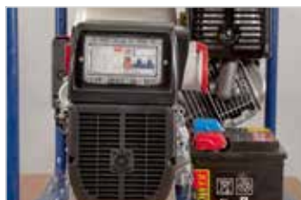
Quadro elettrico superiore trifase con magnetotermico Upper three-phase electrical panel with thermal cut-out protection
