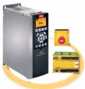
Le VLT® AutomationDrive FC 302 est équipé, en standard, d'une fonction d'arrêt d'urgence qui permet la conformité à la sécurité homme-machine niveau 3 et est conforme à la norme EN 954-1. L'activation de cette fonction empêche toute tension en sortie du variateur FC 302. Ceci représente un avantage incontestable dans les applications où éviter les démarrages involontaires est d'une importance
