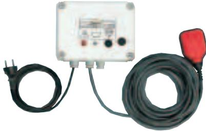
Coffret électronique avec dispositif d'alarme prévu pour le fonctionnement également en cas de coupure de courant avec réserve de charge de 10 heures fournie par batterie tampon au plomb. Fourni avec 1,5 m de câble avec fiche EXPORT DIN 49441 R2 et 1 flotteur avec 10 m de câble type H07-RN-F non raccordé.
