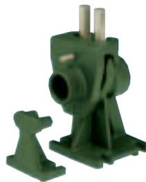
Dispositif de rehaussement pour tubes de guidage de 3/4" Gaz avec: pied d'assise, coulisseau, bride de fixation tubes, colonnettes de guidage du tube et écrou de blocage de la pompe
