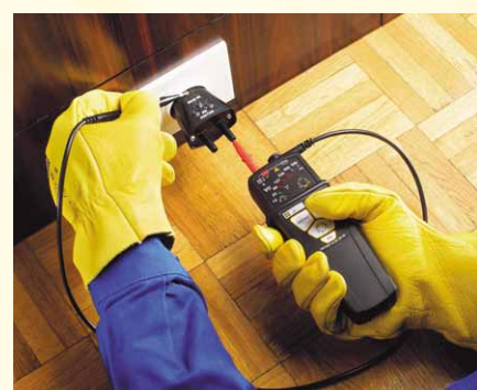
L'ensemble C.A 751 + C.A 760 crée une liaison résistive phase-terre, pour contrôler en toute sécurité le déclenchement d'un disjoncteur différentiel 30 mA sous 230 V AC.
