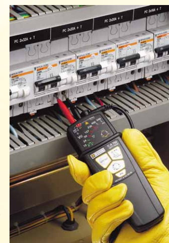
L'entraxe de 19 mm entre les pointes de touche fixées sur le boîtier correspond au pas polaire des disjoncteurs.
