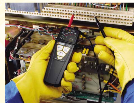
En mesure de tension, les pointes normalisées 2 mm des testeurs accèdent au fond des borniers.
