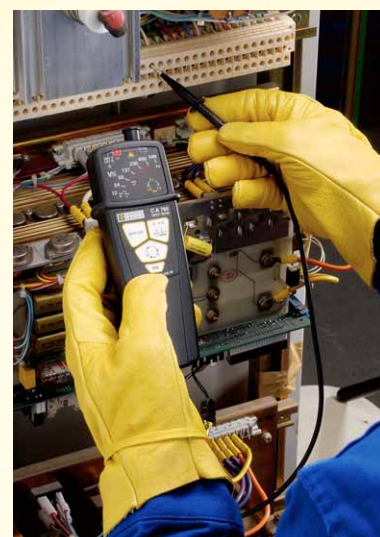
Avec chacun des testeurs, une seule main suffit pour détecter la phase très facilement. Pour le C.A 704, la tension peut se mesurer en parallèle.
