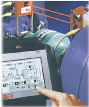
Alignement Laser sur pompes
