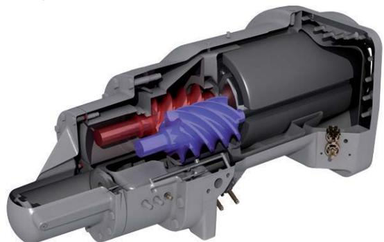
Le compresseur est équipé d'un moteur haute efficacité optimisé pour le fonctionnement du refroidisseur de liquide à condensation à eau. Les rotors utilisent la dernière génération de lobe optimisé pour l'utilisation au R134a. Leur fonctionnement est basé sur un système de roulement à billes surdimensionnés et d'un tiroir de régulation.
