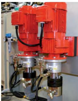
Zahnraddosierpumpe mit aufgebautem Volumenzähler für 2- oder Mehrkomponenten-Dosieranlagen
