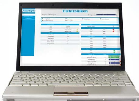
Surveillez vos compresseurs par ethernet à l'aide des nouveaux contrôleurs Elektronikon®, qui incluent notamment les fonctions de surveillance suivantes : alarmes, compresseur à l'arrêt, statut du programme d'entretien.
