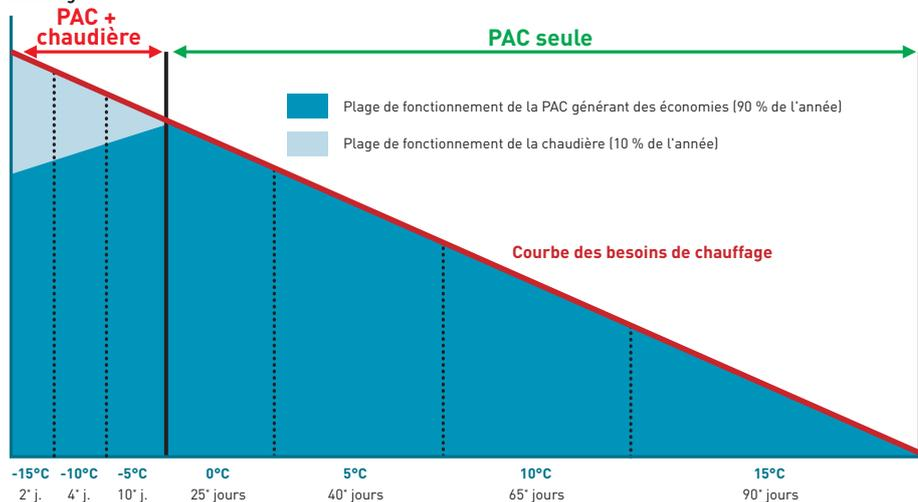
Durant 90 % de la saison de chauffage, la pompe à chaleur assure à elle seule les besoins de chauffage et permet de générer des économies. Durant les 10 % restant, c'est la chaudière existante qui assure le complément nécessaire au confort de l'habitation.
