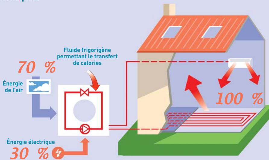
Conçues pour se connecter sur une installation de chauffage existante, **les pompes à chaleur RCH** permettent de chauffer une habitation tout l'hiver et de bénéficier d'une **réduction significative de la facture énergétique**.
