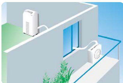
AELIA 10 et 14 CD split-system : Split couplé à un groupe extérieur.
