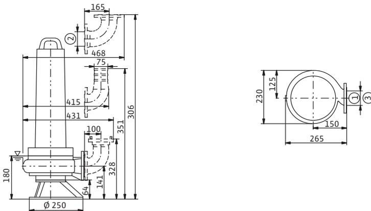
1 = DN80 PN10/ANSI B16.1, classe 125, dimension 3 ; 2 = DN80 PN10 ; 3 = DN65 PN10/ANSI B16.1, classe 125, dimension 2,5
