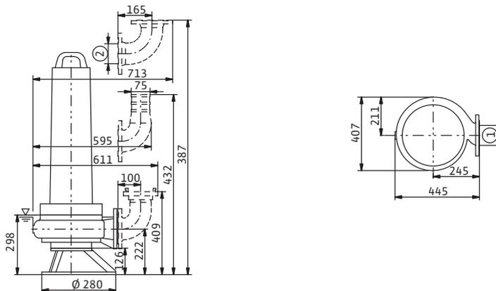
1 = DN80 PN10/ANSI B16.1, classe 125, dimension 3 ; 2 = DN80 PN10 ; 3 = DN100 PN10/ANSI B16.1, classe 125, dimension 4 ; 4 = DN100 PN10
