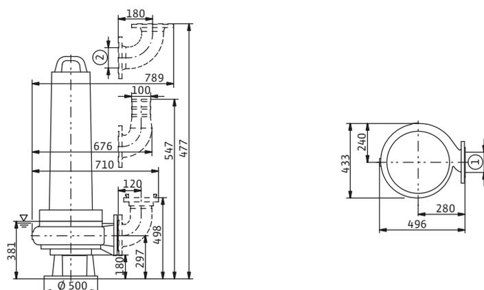
1 = DN100 PN10/ANSI B16.1, classe 125, dimension 4 ; 2 = DN100 PN10 ; 3 = DN150 PN10/ANSI B16.1, classe 125, dimension 6 ; 4 = DN150 PN10
