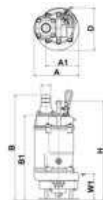
W1: Niveau minimum de pompage
