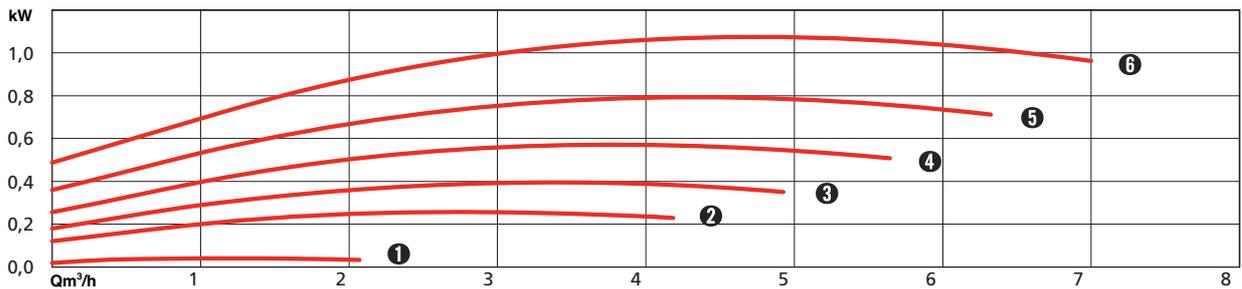
L'intérêt de la variation de vitesse est une nouvelle fois démontrée par le rendement optimal sur une grande plage de débit en comparaison à une pompe à vitesse fixe.
